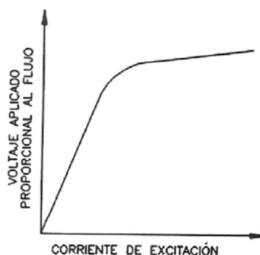
Figura 7-2. Curva de saturación de un transformador.
