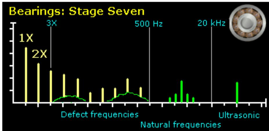
SEPTIMA ETAPA: Con el deterioro del rodamiento aparecen unos montículos característicos. Estos generan un ruido apreciable por el técnico.
