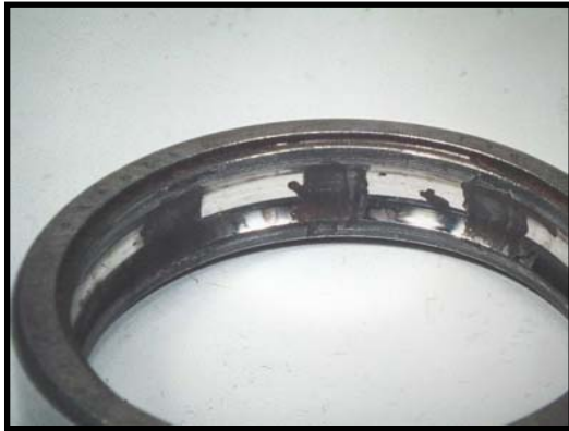
Oxidación en parada (entrada de líquido)
