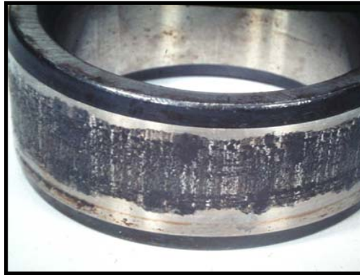
Oxidación en funcionamiento (entrada de líquido)
