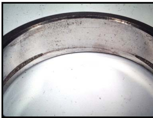
Defecto geométrico del eje y alojamiento en rodam. de bolas
