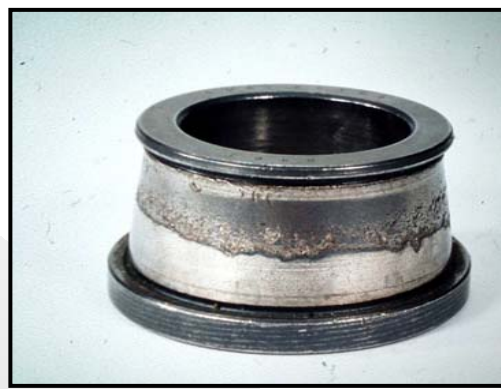
Defecto geométrico del eje y alojamiento en rodam. cónicos
