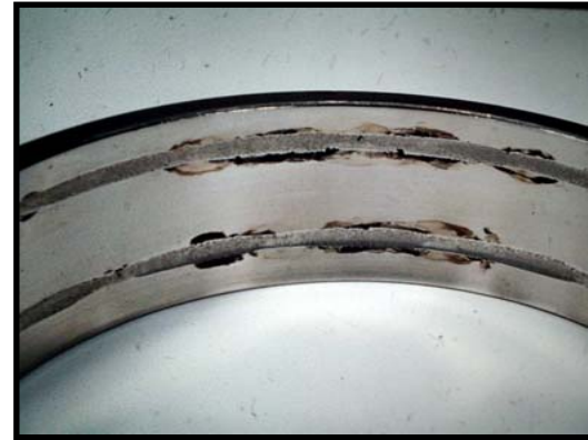
Oxidación y desgaste en rotación (entrada de líquido con relubricación)
