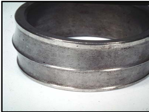
Desgaste debido a entrada de abrasivo
