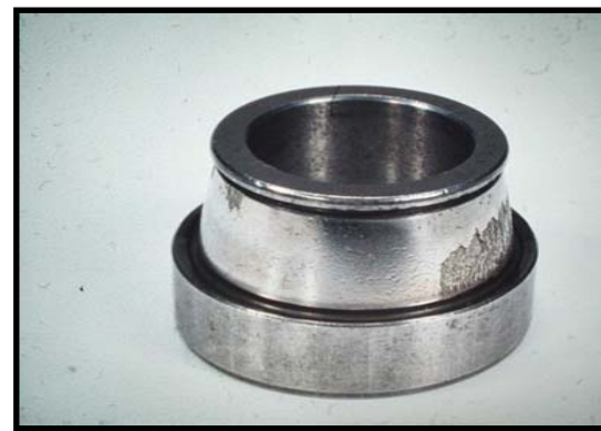
Deterioro del cono debido a defecto de alineamiento
