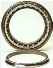
Rodamiento palier I del Turboreactor CFM 56
