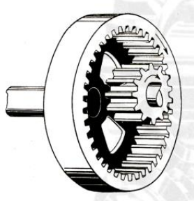
Engranajes cilíndricos rectos con contacto interno
