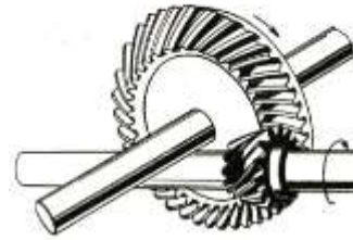
Engranajes cónicos hipoidales
