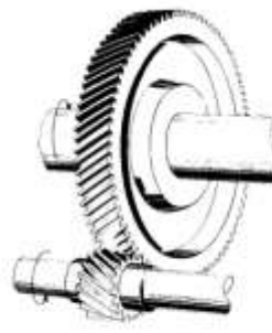
Engranajes cilíndricos helicoidales
