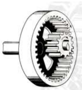
Engranajes cilíndricos rectos con contacto interno
