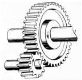
Engranajes cilíndricos rectos con contacto externo
