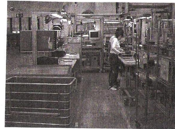
Figura 3.4. Célula en U de ensamblaje. Proceso cíclico, manual unidad por unidad.
