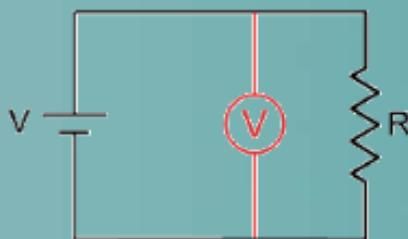
Para medir la diferencia de tensión entre dos puntos del circuito hay que **conectar las puntas de prueba en paralelo** con esos dos puntos, teniendo en cuenta su polaridad como en el caso del amperímetro. Lo que se mide siempre son diferencias de potencial, por lo que hay que conectar las dos puntas del aparato, tomándose la tensión en una de ellas como la tensión de referencia de la otra. Normalmente se toma como referencia la tensión de la punta negativa.
