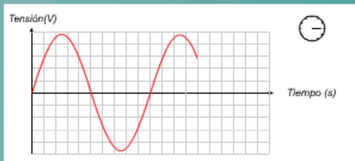
La tensión alterna sinusoidal queda caracterizada por la amplitud (o valor máximo que adquiere la onda) y por su frecuencia (o número de veces que se repite su ciclo en un segundo).
