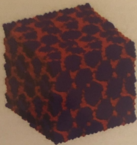
Figura 2.15. Estructura de una aleación níquel-tungsteno. Los cristales azules están hechos sobre todo de níquel, mientras que las regiones rojas están hechas mayormente de tungsteno.
