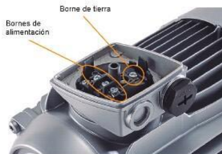
Figura 6.24. Caja de bornes de un motor de conexión directa. Se pueden apreciar los tres bornes de conexión de los conductores de fase, así como el borne de puesta a tierra. (Cortesía de Siemens.)
