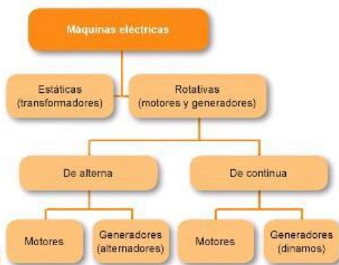
Figura 6.1. Clasificación de las máquinas eléctricas.
