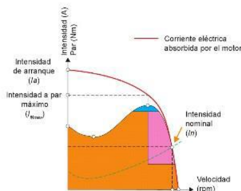
Figura 6.37. Curva característica par-velocidad-intensidad de un motor.
