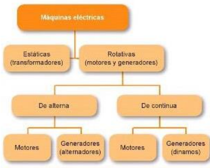
Figura 6.1. Clasificación de las máquinas eléctricas.
