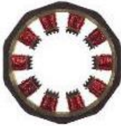
Figura 6.6. Sección en alzado de un estator.
