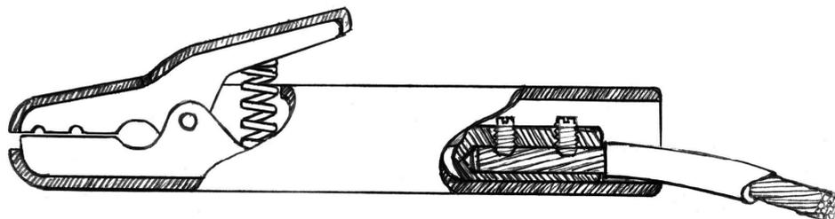
Las mandíbulas suelen ser de bronce (buen conductor eléctrico, pero algo pesado) o bien de acero y con las puntas de cobre o bronce (mas económico y liviano), los aislamientos varían desde algún tipo de plástico, caucho-goma, o comúnmente de "baquelita".
